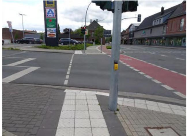
Abbildung 58: Bodenindikatoren, gesicherte und getrennte Querung als Ampel/LSA in Oelde, Warendorfer Str. / Am Bahnhof
