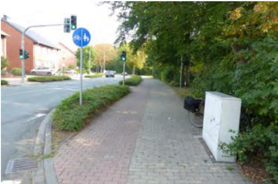
Abbildung 37: Visuell etwas abgesetzter aber taktil nicht wahrnehmbarer Radweg an der Emanuel-von-Ketteler-Straße
